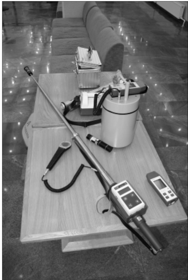
Parodoje eksponuoti nešiojamieji matuokliai, skirti dozės galiai, neutronų kiekiui bei paviršinei taršai radionuklidais nustatyti
